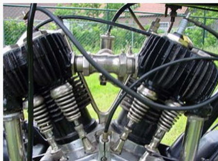
Zijklepmotor van AJS uit 1920: de kleppen staan ondersteboven naast de cilinders. De klepveren zitten eromheen. V.l.n.r.: De uitlaatklep van de achterste cilinder, de inlaatklep van de achterste cilinder, de inlaatklep van de voorste cilinder en de uitlaatklep van de voorste cilinder.
