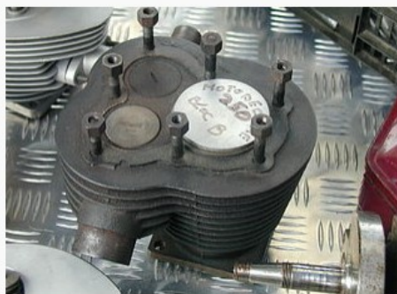
Bovenaanzicht van de cilinder van een zijklepmotor: links de kleppen, rechts de zuiger
