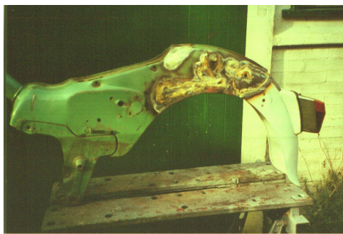
Hardsolderen nieuwe stukken plaat in C50 frame.
